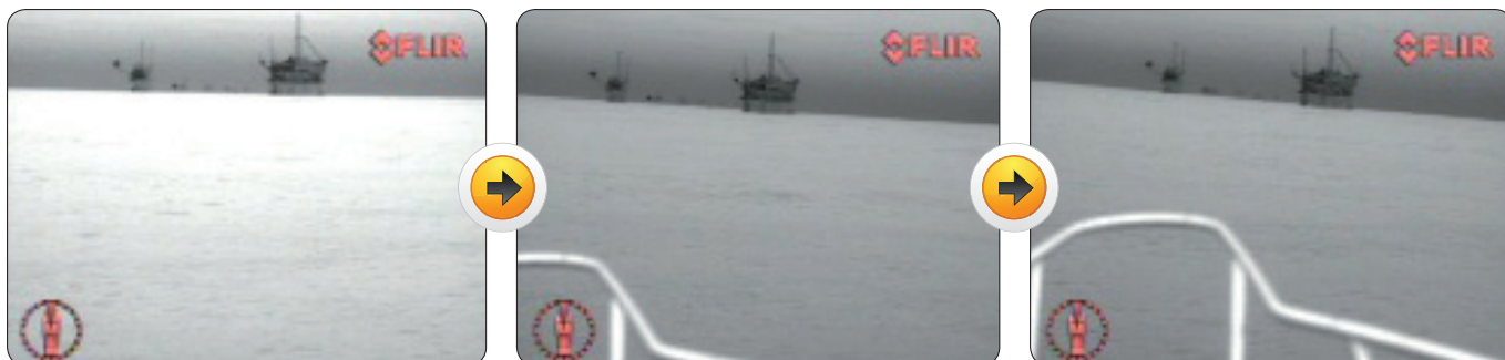
Gyro-stabilizowany przetwornik, zapewnia nieruchomy obraz pomimo zafalowania.
